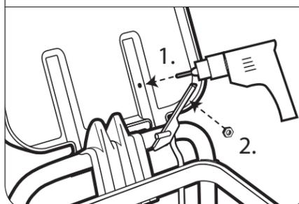
6. 1. Positionnez la fixation pour pédale à l'endroit encastré. Installez à l'aide de deux vis. Serrez uniquement pour que les vis pénètrent le plastique, si vous serrez trop vous pourriez endommager le plastique.
