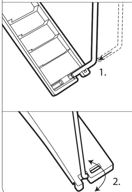
3. 1. Positionnez la pédale sous le chariot, entre les deux boulons d'ancrage. Installez-la sur la barre centrale de la base du chariot.
